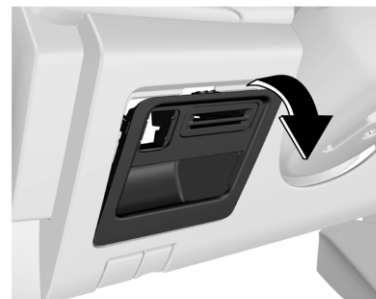
Caja de fusibles interior
